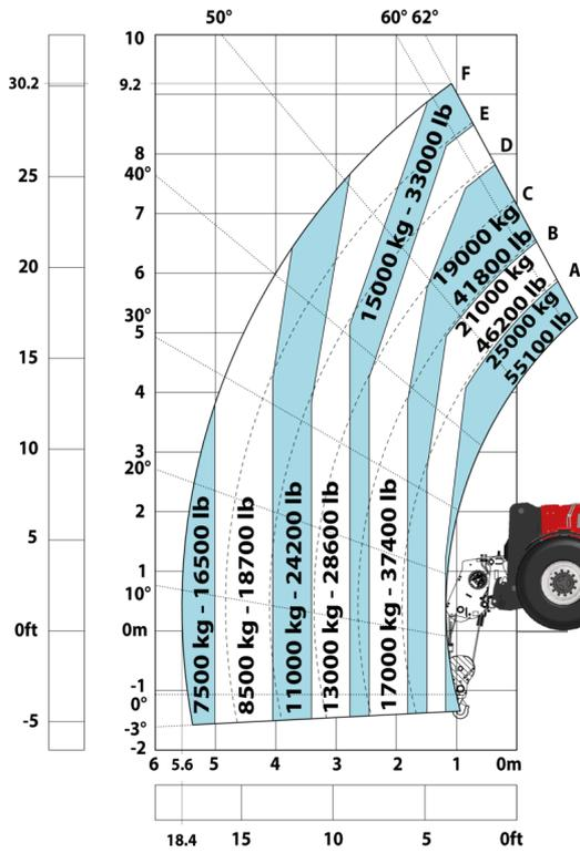
Machine sur pneus avec treuil 25000 kg (Imperial)
