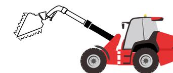
**Retour automatique à la charge:** pour revenir facilement à une position (accessoire et flèche) pré-établie par l'opérateur. Cette fonction est particulièrement intéressante pour des opérations de chargement.
