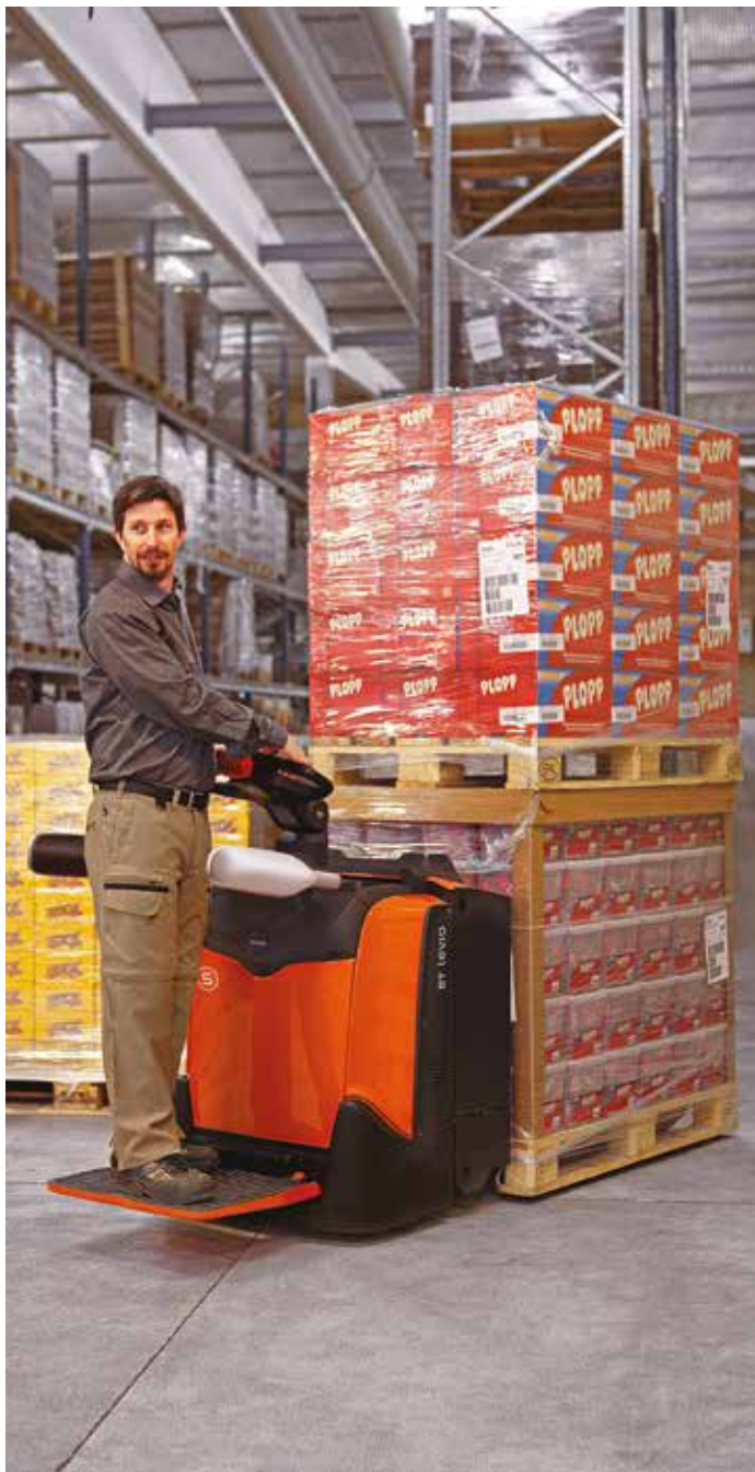
Le timon est réglable en hauteur sur simple pression d'un bouton
