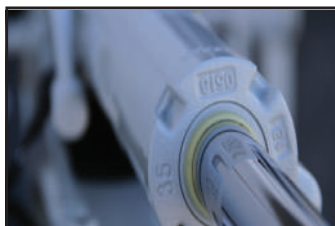
Vérin de flèche en position supérieur
