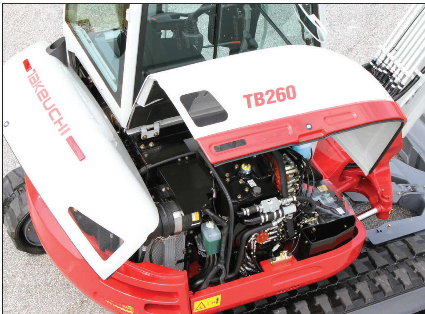
Les grands capots de service verrouillables offrent un accès de maintenance exceptionnel.
