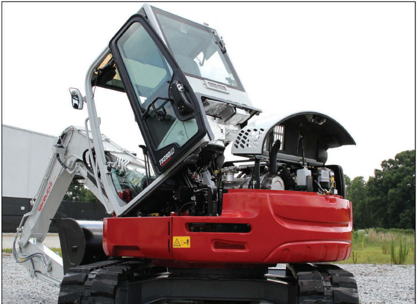
Cabine basculante pour un accès aisé aux différents composants hydrauliques
