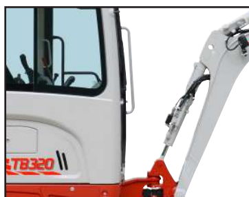
Vérin de flèche monté en haut
