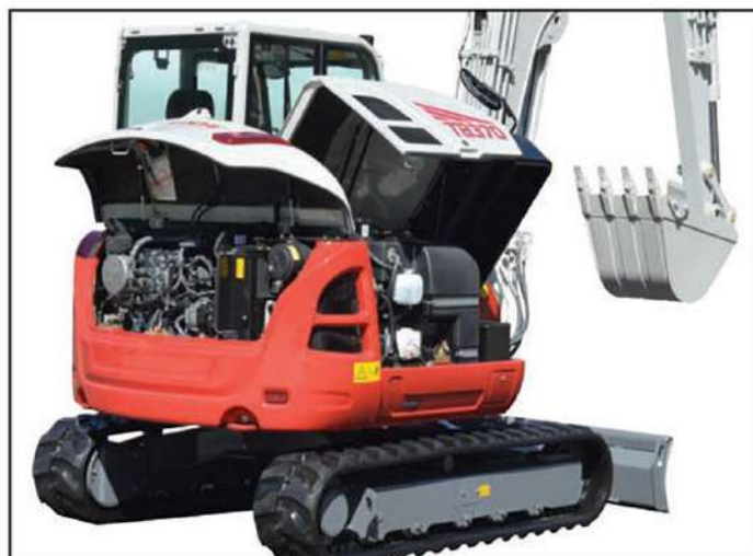
Accessibilité pour une maintenance aisée
