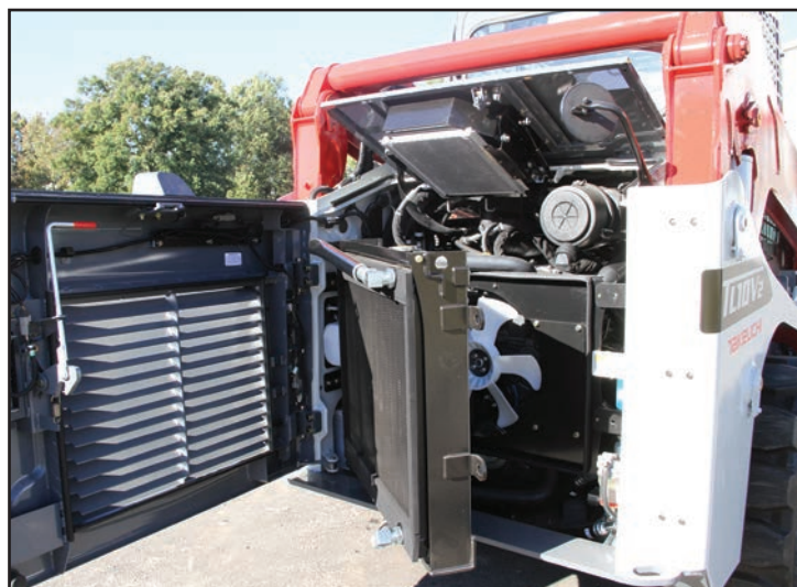
Facilité d'accès pour la maintenance
