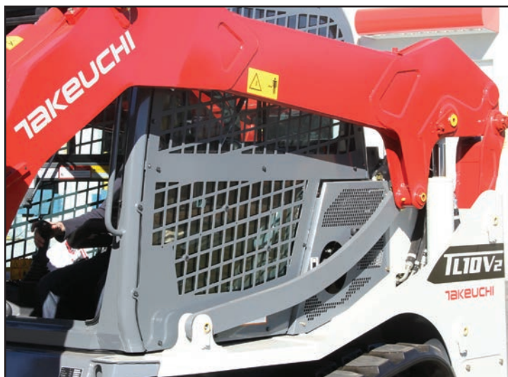
Bras de levage vertical pour plus de stabilité
