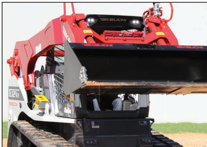
Bras de levage vertical pour plus de stabilité
